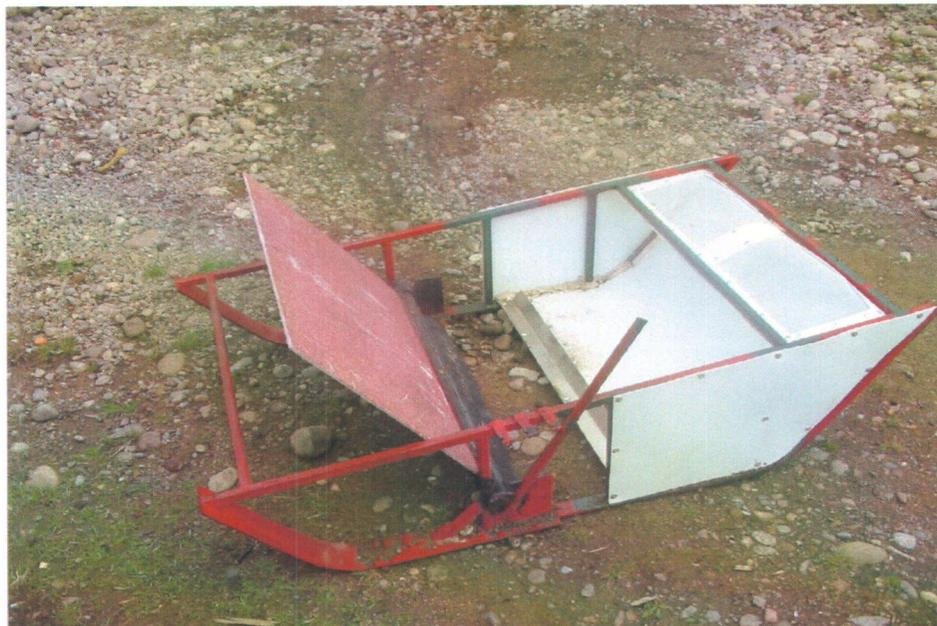
Figure 7.1 A) Photos de la base-griffée utilisée pour démobiliser le substrat
