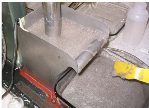
Figure 14 : Aspect de la mousse lors des essais de flottation
