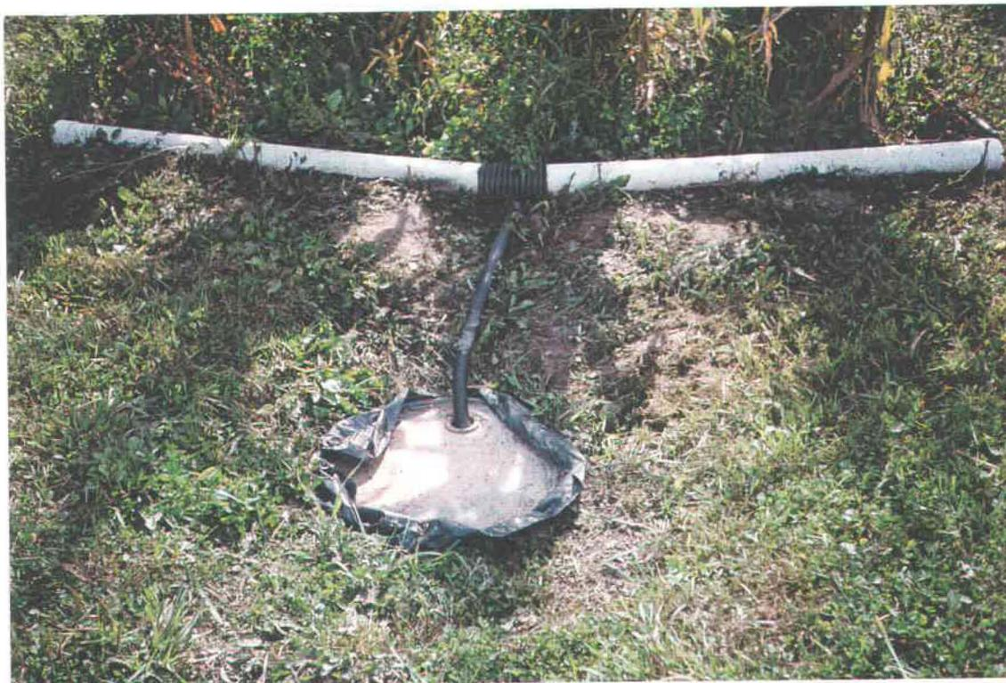
Les échantillons d'eau sont recueillis sur une base d'événements pluvieux. Les bioessais ont été réalisés sur trois de ces collectes soit T0 (avant toute fertilisation); T1 (après la fertilisation azotée) et T2 (en fin de saison). Un échantillonnage au temps T3 a été fait sur quelques parcelles afin de suivre l'évolution de la toxicité en fonction du temps.
