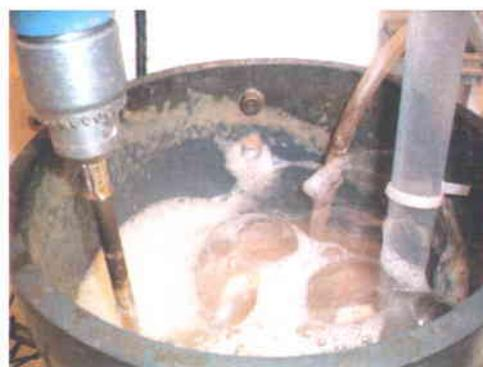
Figure 3.5 Photographie de la liqueur mixte du BRM lorsque la charge volumique de BPA est supérieure à 21,6 g.m<sup>-3</sup>.jr<sup>-1</sup> (Apparition de mousse, diminution de MES)
