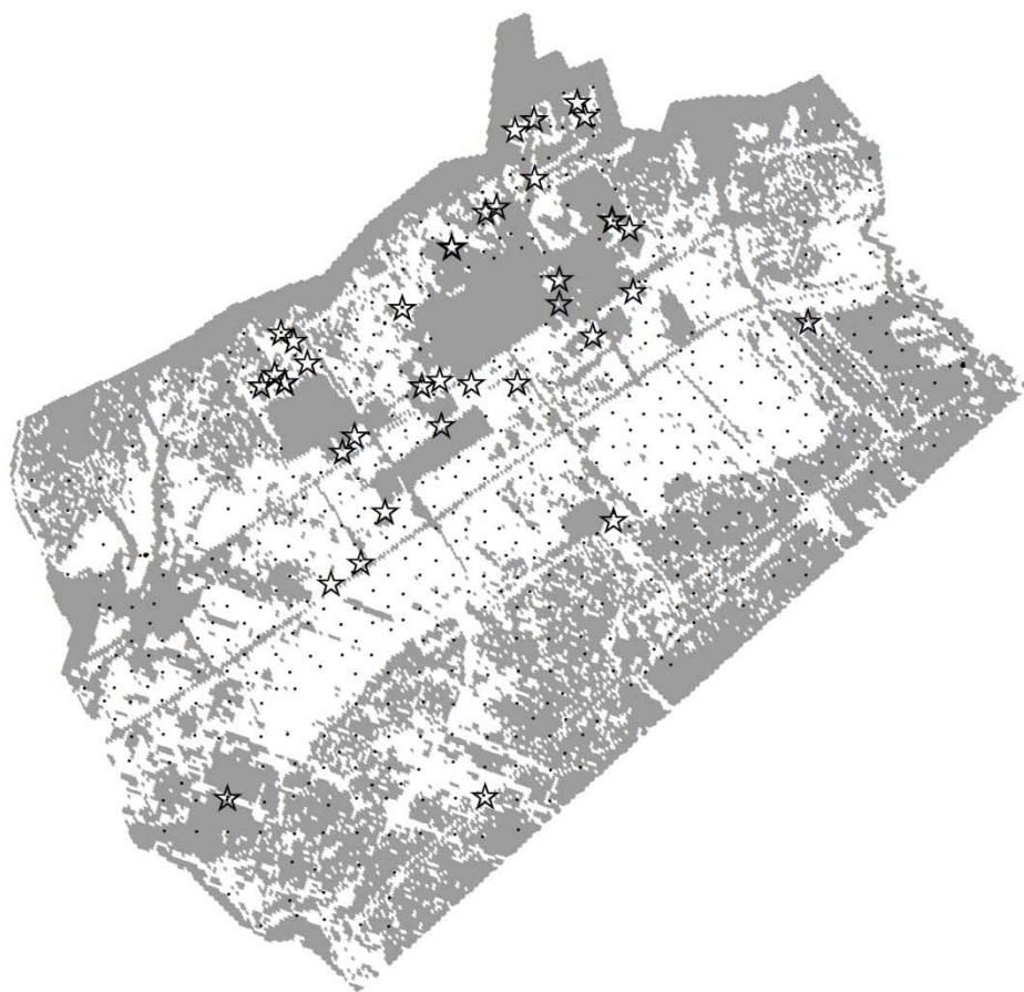
Figure 35. Localisation des anomalies en hydrocarbures gazeux observées (étoiles) et superposition aux anomalies prédites comme absentes (pixels gris) et présentes (pixels blancs).
