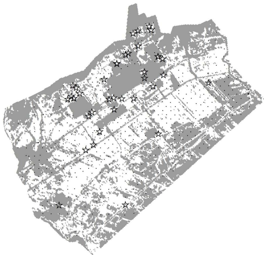
Figure 40. Localisation des anomalies en hydrocarbures gazeux observées (étoiles) et superposition aux anomalies prédites comme absentes (pixels gris) et présentes (pixels blancs).
