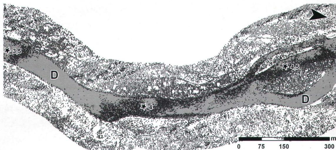
Figure 26 : Discontinuités spatiales (D) dans le relevé LiDAR au niveau du chenal.
