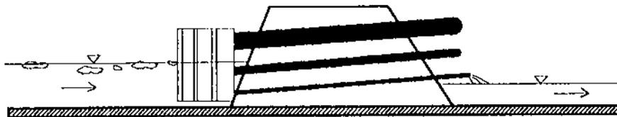
**Figure 1-10 : Exemple de conduites formant un seuil de contrôle à l'exutoire du bassin de sédimentation (tiré de Klove, 2000).**
