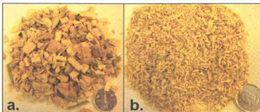
**Figure 17** Photographie illustrant la différence de taille de particules entre les copeaux de bois (0 – 12 mm) situés à gauche (a.) et les sciures de bois ou bois broyés (0 – 2 mm) situés à droite (b.)
