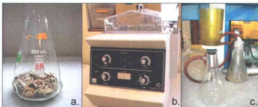
**Figure 14** Photographie des équipements de remédiation à l'échelle laboratoire: a. Erlenmeyer à chicanes utilisé lors de l'étape de lixiviation, b. Table oscillante avec bain-marie, c. Séparation solide/liquide par filtration
