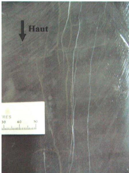
**Figure 3.3 : Fractures cimentées subverticales à 3335 m**
