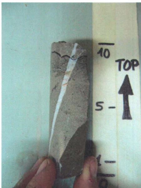
Sur la figure 3.6, les relations de recoupement entre fractures et stylolithes montrent que la cimentation des fractures par de la calcite est antérieure au développement des stylolithes.
