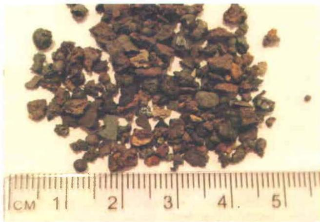
Figure 1.10 Photographie des déchets métallurgiques riches en oxydes de Fe (fraction 2 – 5 mm).
