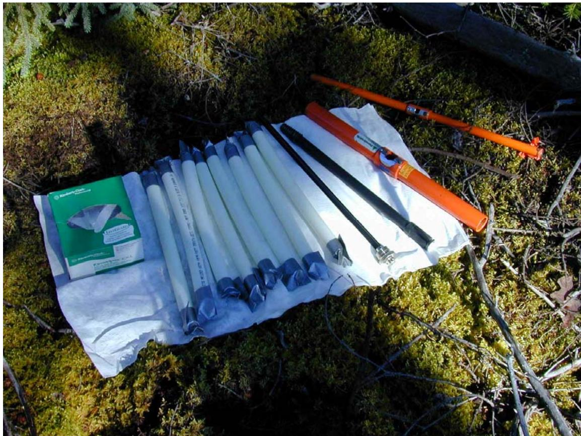
Figure 23. Matériel de prélèvement des carottes d'arbres. Le diamètre du carottier utilisé (à droite) est de 8 mm celui de gauche est de 12 mm. Chaque carotte est isolée dans un tube individuel préalablement décontaminé.
