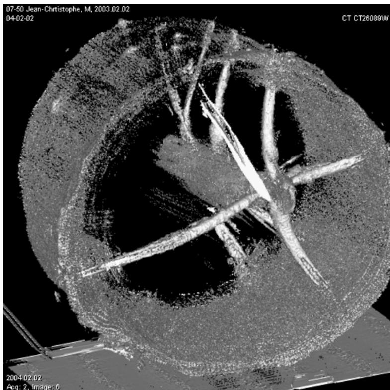
Figure 7. Hétérogénéité de la tige de l'arbre. Les différences de tons de gris sont liées à des différences de densité du bois. Par traitement numérique, les densités inférieures à 1 ont été éliminées. La couronne radiale montre les cernes impliqués dans le transport de la sève. Les structures internes montrent l'hétérogénéité du tronc de l'arbre (Laboratoire de tomographie de l'INRS-ETE).
