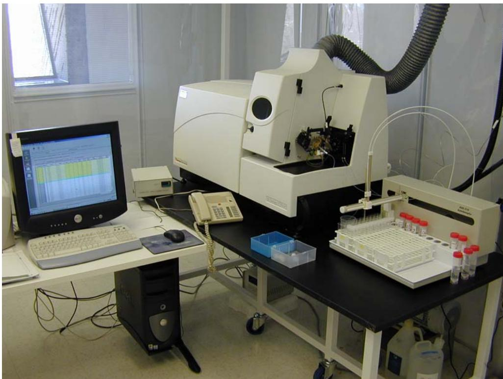
Figure 26. Spectromètre de masse (ICP-MS, série Thermo X).
