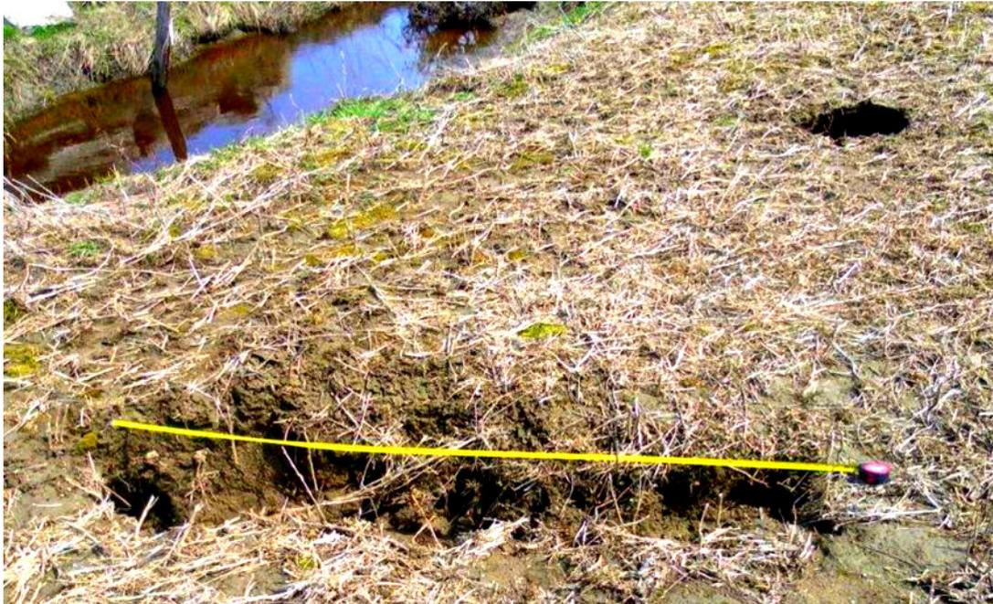
Figure 30. Érosion en tunnel.
