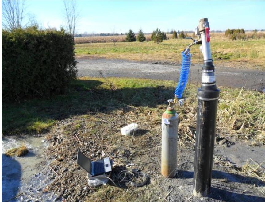
Figure 13 : Instrumentation pour l'essai de perméabilité pneumatique sur le puits P13
