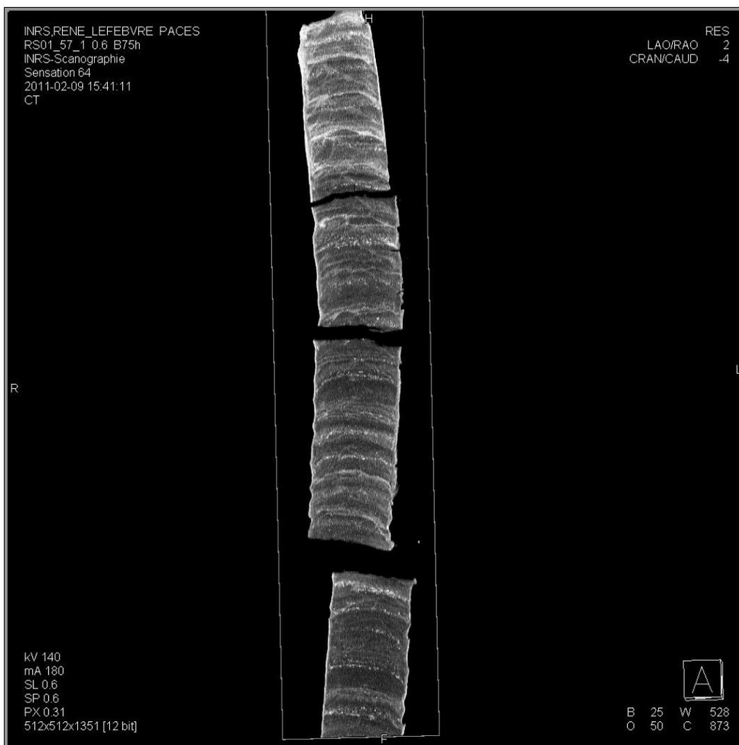
Figure 17 : Exemple de scan d'un échantillon de sol prélevé lors des forages rotonsonic
