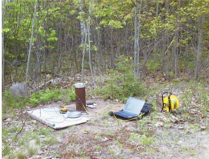
Figure 12 : Opération d'installation d'un capteur de pression dans un puits d'observation
