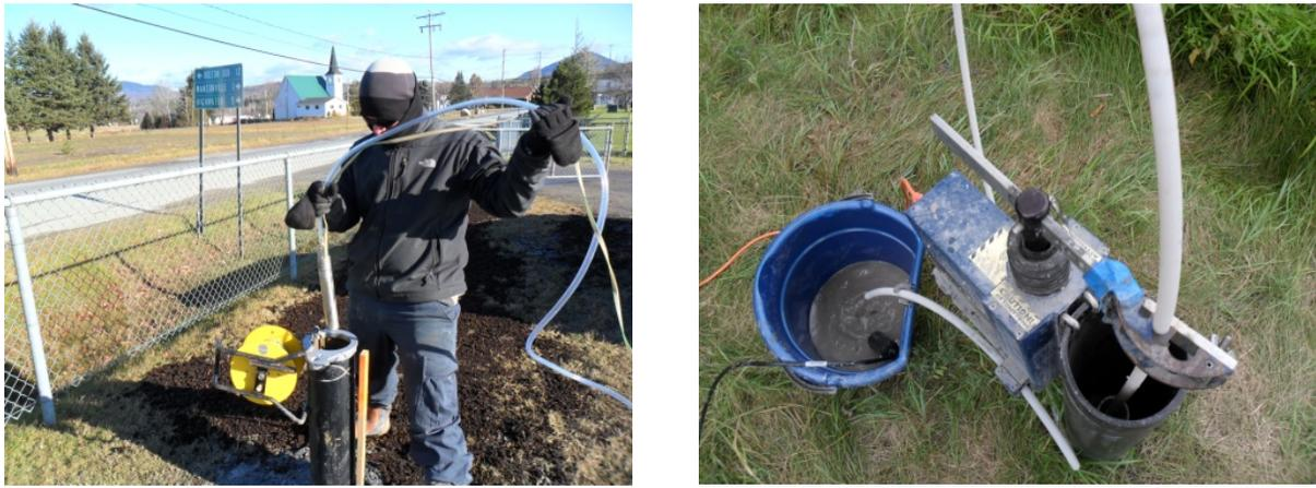
Figure 15 : Pompes utilisées pour la purge et l'échantillonnage des puits d'observation
