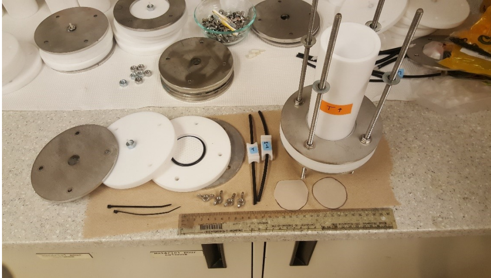
Figure 3-10: Pièces pour la conception d'une colonne en Téflon
