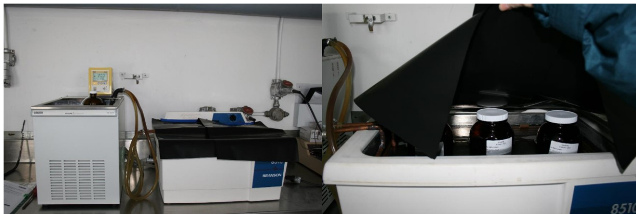
Figure 3-3: Bain ultra-son relié à un bain thermostaté pour les essais à 20 et 40°C (De l'huile minérale a été utilisée en remplacement à l'eau à 40°C afin d'éviter l'assèchement du bain thermostaté)
