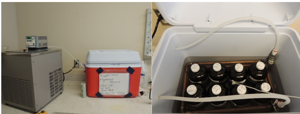
Figure 3-6: Système de contrôle de la température à 15°C dans une glacière reliée au bain refroidissant.
