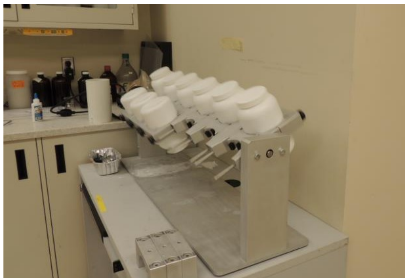
Figure 3-5: Agitateur mécanique utilisé pour les essais de partition (certifié ASTM).
