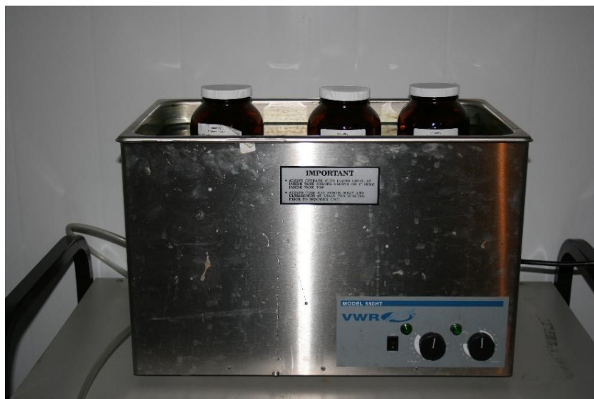
Figure 3-2: Bain ultra-son installé dans une chambre thermostaté à 5°C.
