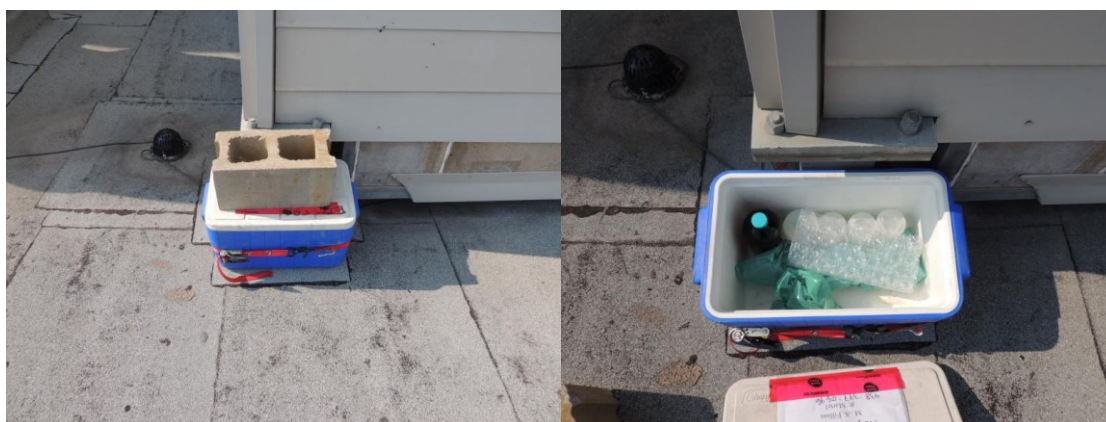
Figure 3-14: Glacière comprenant les solutions contrôle lors des essais de photodégradation en 2018
