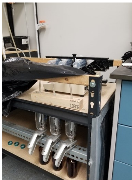
Figure 3-7: Montage des essais de dissolution par gouttes adapté sur une table.
