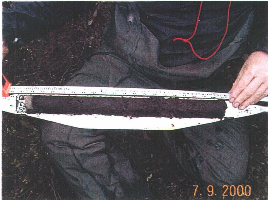
Figure 10 : Échantillon basal et contact entre les sédiments organique et minéral
