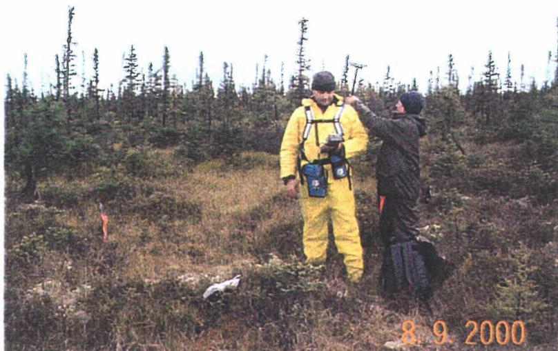
**Figure 6 : Enregistrement électronique des coordonnées GPs à partir d'un appareil Lo-K-tor à 12 canaux**
