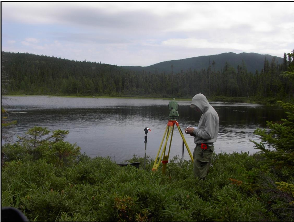
Figure 13 : Levé bathymétrique à l'aide d'une station totale.
