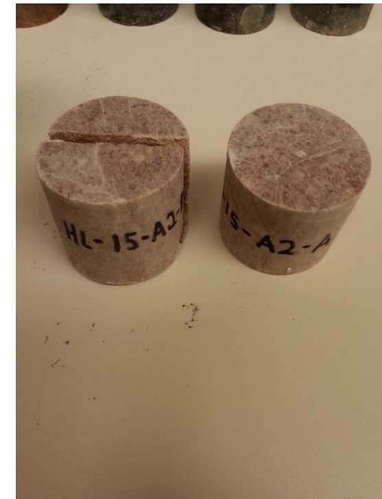
Photo de l'échantillon de gypse fracturé HL-15-A2-B (gauche) et l'échantillon de gypse intact HL-15-A2-A (droite).
