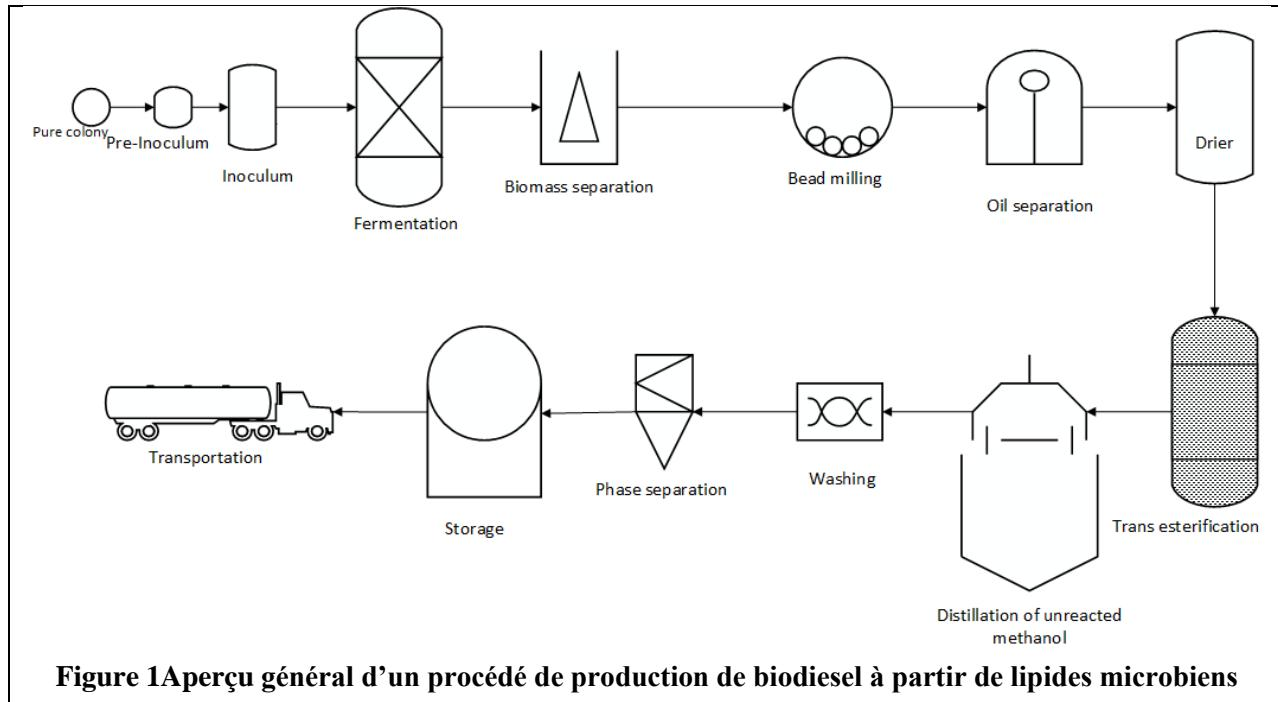
**Figure 1Aperçu général d'un procédé de production de biodiesel à partir de lipides microbien**
