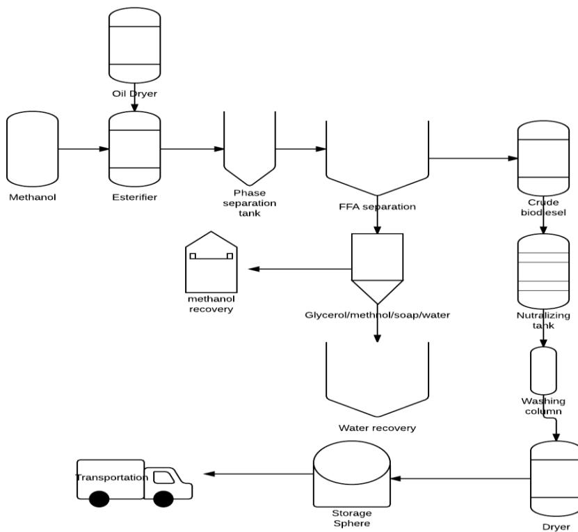
Figure 5 Étapes schématiques du processus de la transésterification
