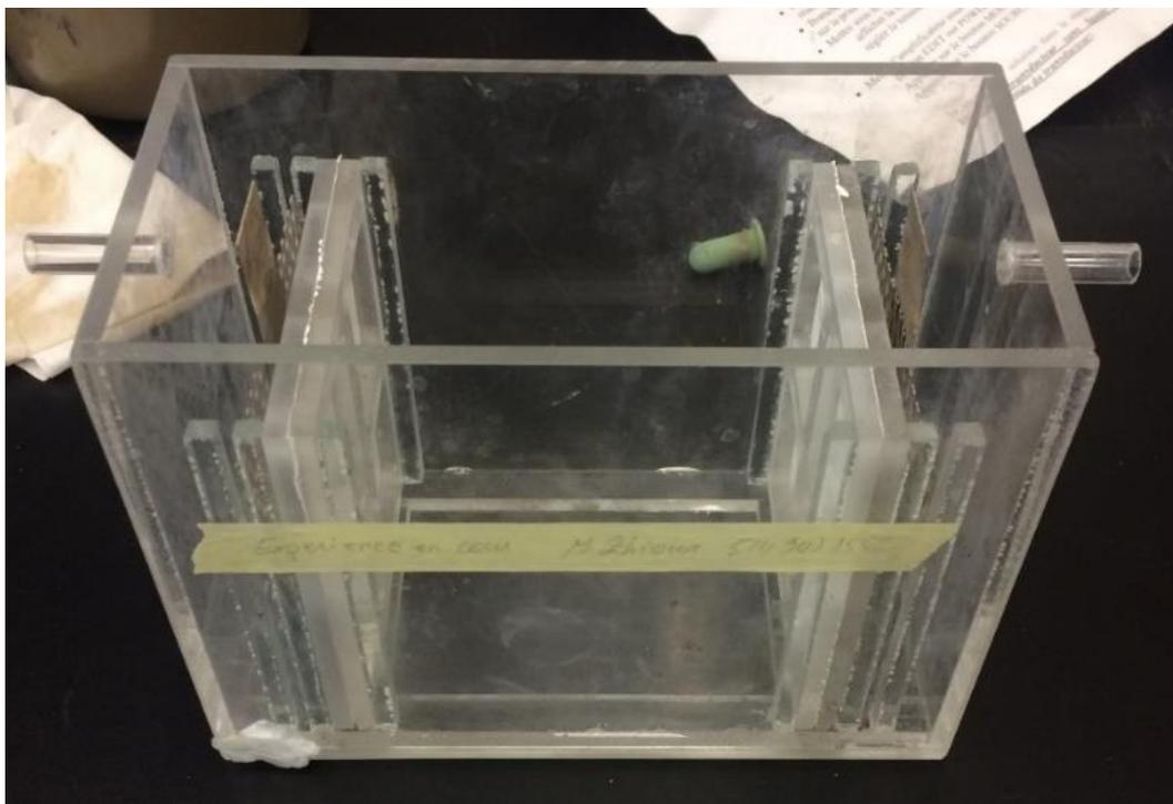
**Figure 6-1 Réacteur utilisé pour toutes les expériences**
