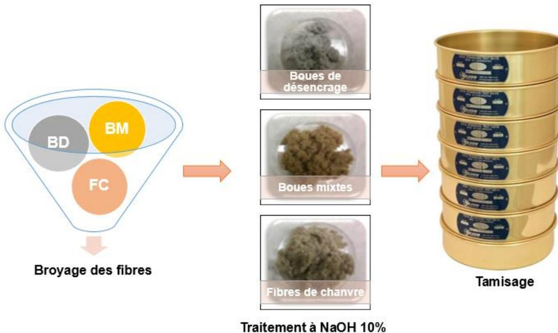
Figure 14: Schéma des étapes du traitement physico-chimique effectué.
