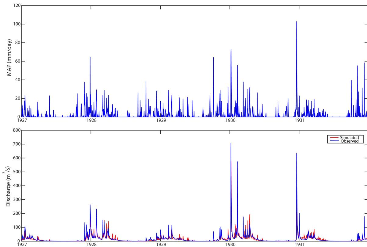
**Figure 16.** Simulation de calibrage pour le modèle hydrologique TOPKAPI-X appliquée au bassin Flumendosa. La décharge observée est comparée contre la simulé. Dans le panneau supérieur la série de précipitation régionale moyenne calculée avec les 14 indicateurs de pluie pendant la période 1927-1931 est rapportée.
