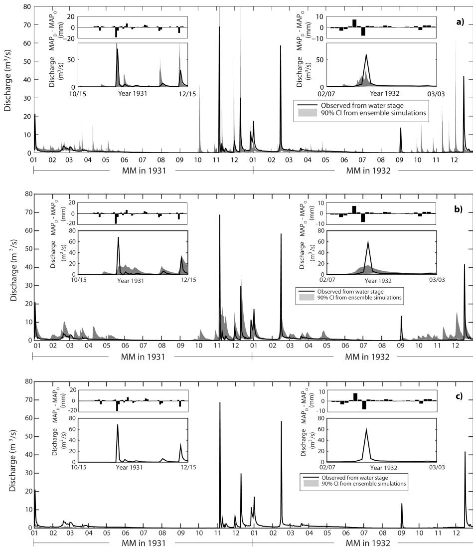
**Figure 6.** Résultats pendant les années de validation 1931-1932 pour les modèles tRIBS (a), TOPKAPI-X (b), et CATHY (c), comparant la décharge observée contre les intervalles de confiance de 90 % (CI) tiré des 50 simulations d'ensemble des modèles tRIBS, TOPKAPI-X et CATHY. Dans les encarts, on montre un agrandissement sur deux périodes avec des événements d'inondation significatifs pour mieux visualiser la comparaison et la différence entre MAP<sub>D</sub> quotidien et MAP<sub>O</sub>.
