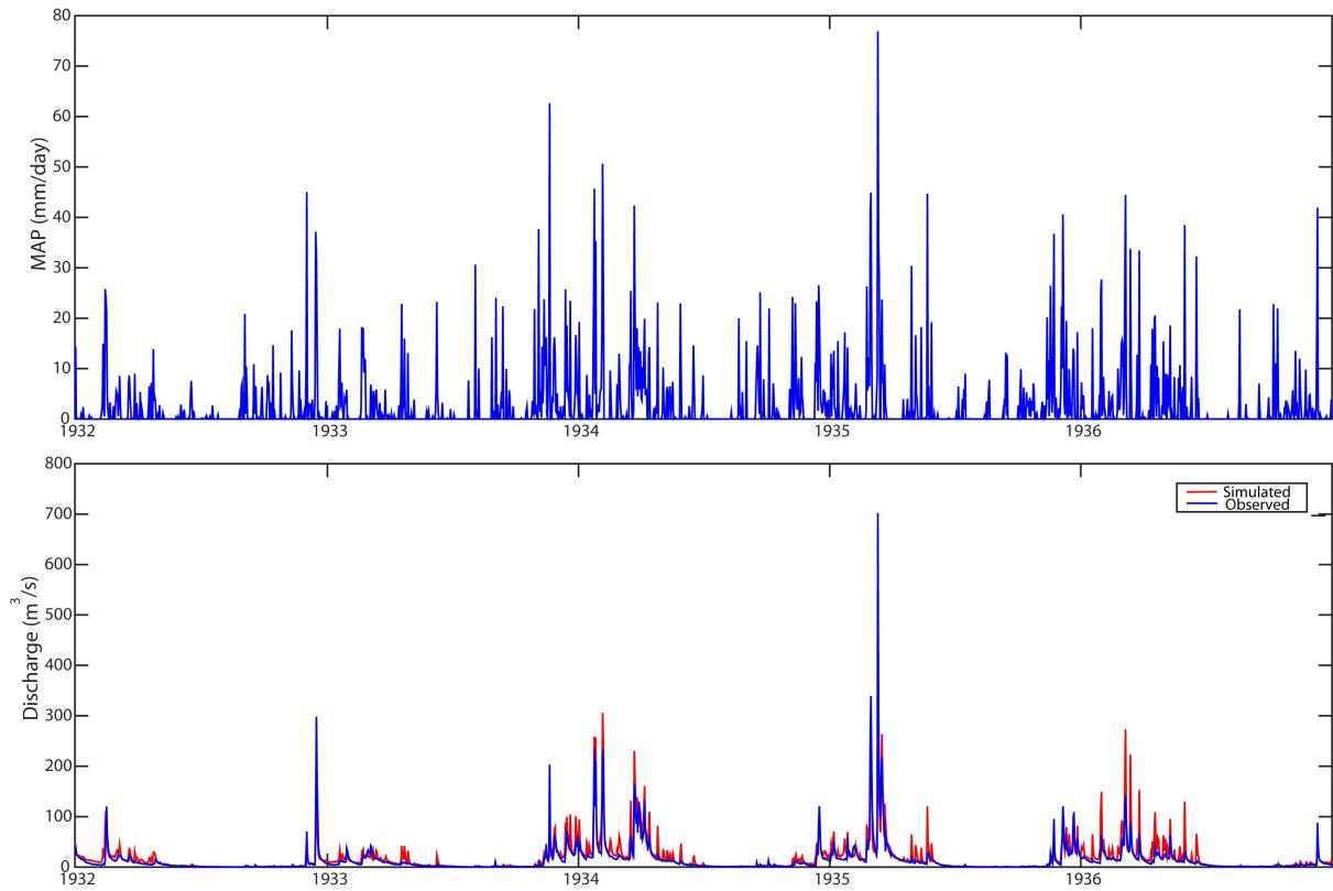
**Figure 17.** Simulation de validation pour le modèle hydrologique TOPKAPI-X appliqué au bassin Flumendosa. La décharge observée est comparée contre la simulé. Dans le panneau supérieur la série de précipitation régionale moyenne calculée avec les 14 indicateurs de pluie pendant la période 1932-1936 est rapportée.
