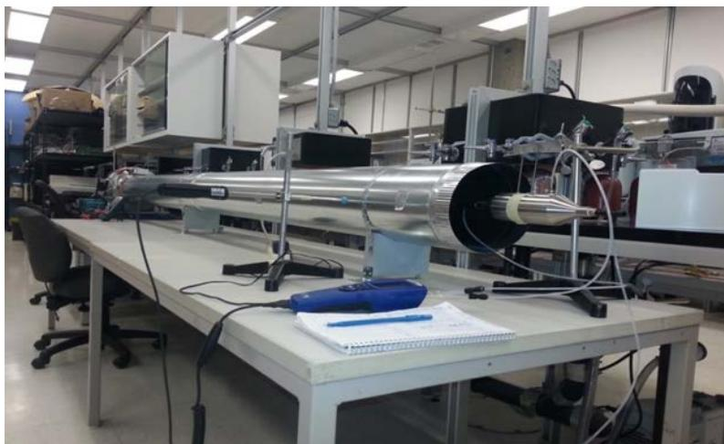
**Figure 4.4 Évaluation de la vitesse et de la différence de pression dans un tunnel de vent.**
