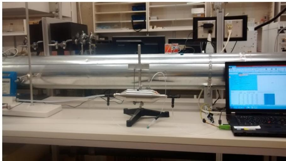
**Figure 4.5 Évaluation de la perte de pression en fonction du débit de l'air (test en ligne).**
