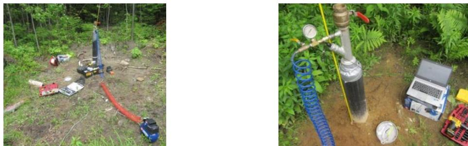
**Figure 1 Matériel utilisé pour réaliser les essais par la méthode pneumatiques.**
