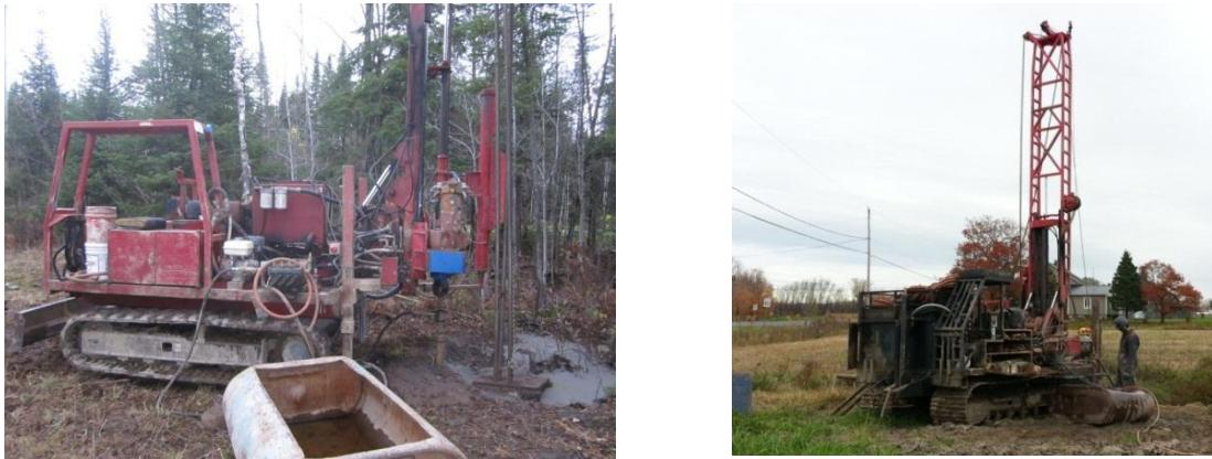
**Figure 1 Forage carotté (au diamant) : puits F4 (a.) et F7 (b.).**
