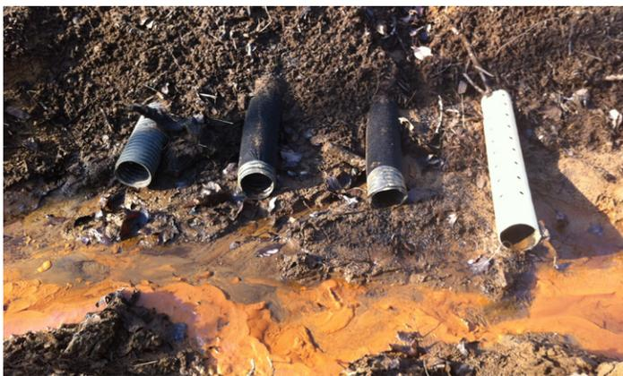
Figure 8: Les quatre drains recouverts de différents matériaux.
