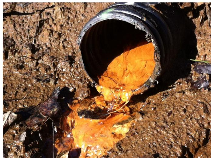
Figure 1 : Dépôt d'ocre dans un drain agricole.
