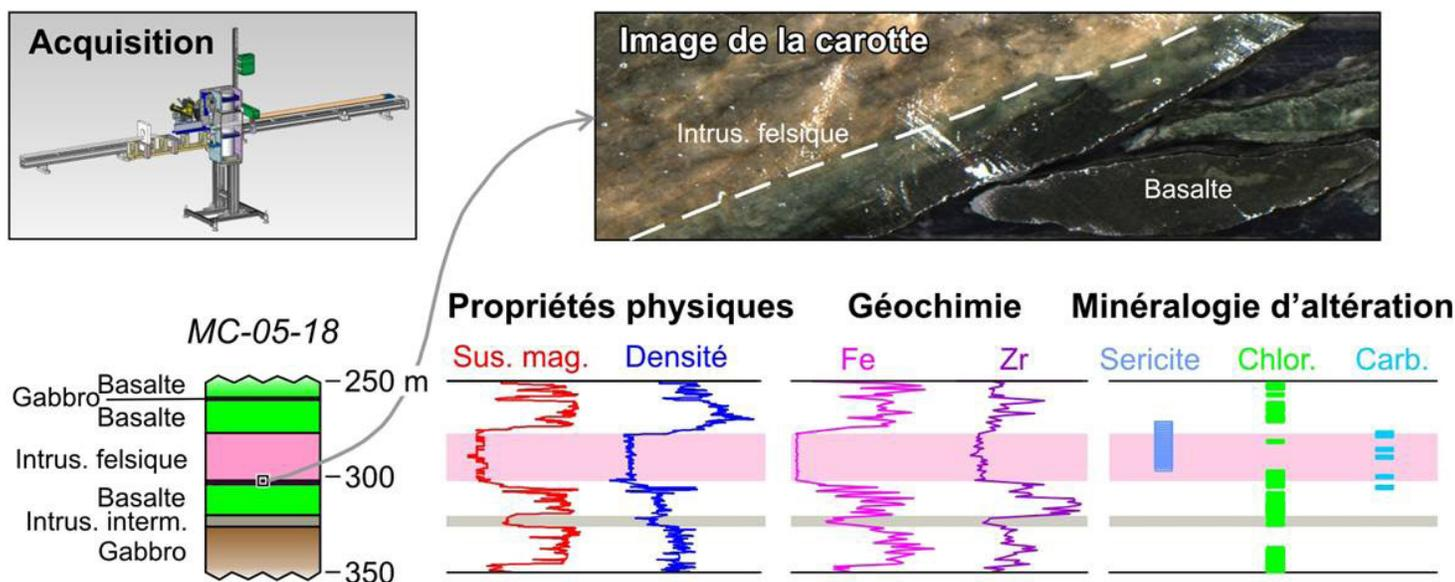
**Figure 3 :** Résultats obtenus grâce au LAMROC incluant une image de la carotte, une représentation des lithologies et des graphiques des propriétés physiques, géochimiques et minéralogiques des roches.
