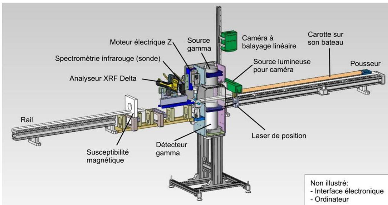
Figure 2 : Schéma du système d'acquisition du LAMROC.
