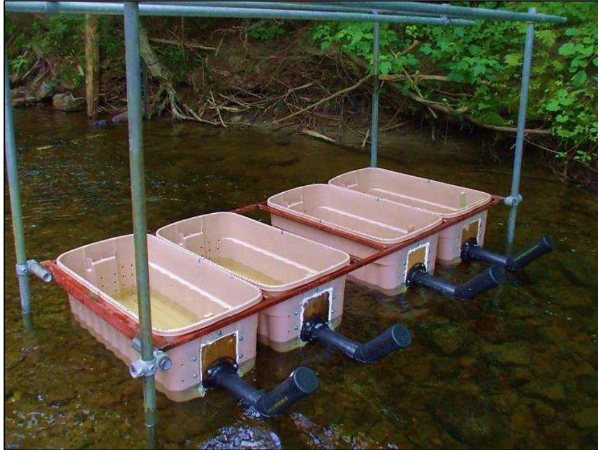
Figure 14. Bassins utilisés lors des essais comportementaux, in situ . Les poissons sont introduits dans le bassin à partir des tuyaux de PVC noirs. L'eau s'écoule dans les arènes de façon naturelle.
