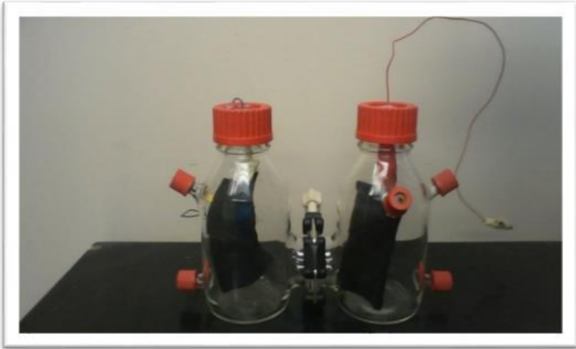
Figure 12. Montage de la cellule cylindrique C2
