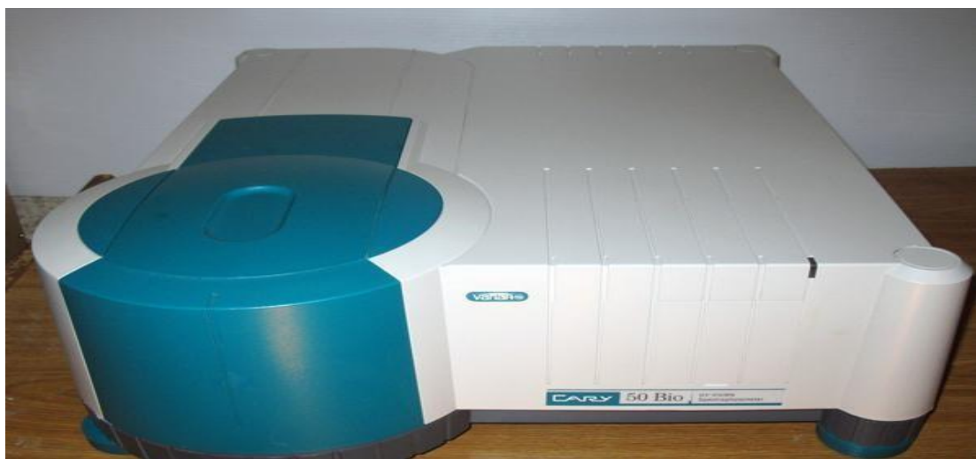
Figure 13. Spectrophotomètre pour l'analyse de la DCO, sucres réduits et la densité optique
