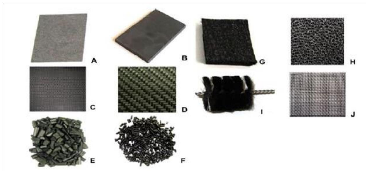
Figure 7. Photographie des matériaux de cathode les plus couramment utilisés : (A) Papier carbone, (B) Plaque de graphite, (C) Tissu de carbone, (D) Grille de carbone, (E) Granules de graphite, (F) Granules de charbon actif, (G) Feutre de carbone, (H) Carbone vitreux réticulé, (I) Brosse de carbone, (J) Grille d'acier inoxydable. Tiré de (Wei, Liang et al. 2011)
