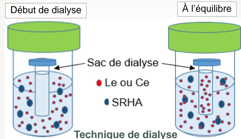
Les concentrations de La et de Ce ajoutés séparément varient entre 350 nM et 5000 nM. Les sacs de dialyse ont un seuil de porosité 100 Da. Ils ont été remplis avec une solution d'ions majeurs. Le pH est ajusté à 5. À l'équilibre, les complexes M-SRHA ( $>100$  Da) vont rester à l'extérieur. Cette fraction est déterminée selon l'équation :  $[M_{\text{int}}] - [M_{\text{ext}}] = [M\text{-SRHA}]$  avec M : La ou Ce
