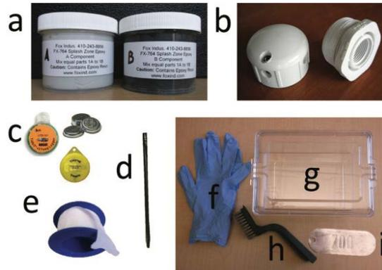
**Figure A 4:** Équipement nécessaire pour installer des thermographes avec la méthode époxy a) époxy FX-764 séparé FOX ; b) bouchon en PVC ; c) thermographes ; d) «tie-wrap» ; e) ruban de téflon ; f) gants de caoutchouc ; g) contenant en plastique ; h) brosse en acier ; i) étiquette en métal.
