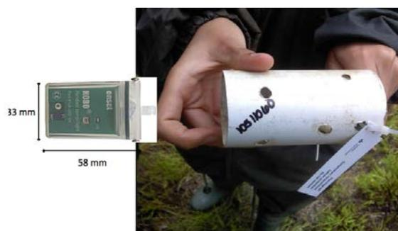
**Figure A 1:** Vue du thermographe et du tube de PVC perforé. Le numéro du thermographe est écrit sur le tube. Le thermographe est attaché au tube à l'aide d'un petit «tie-wrap». Les trous dans le tube permettent la circulation de l'eau autour du thermographe et éviter la surchauffe dans le tube. La couleur blanche permet de limiter l'absorption des rayons solaires.
