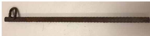
**Figure A 2:** Tige d'acier de 0,6 m de long avec un œillet soudé au bout.
