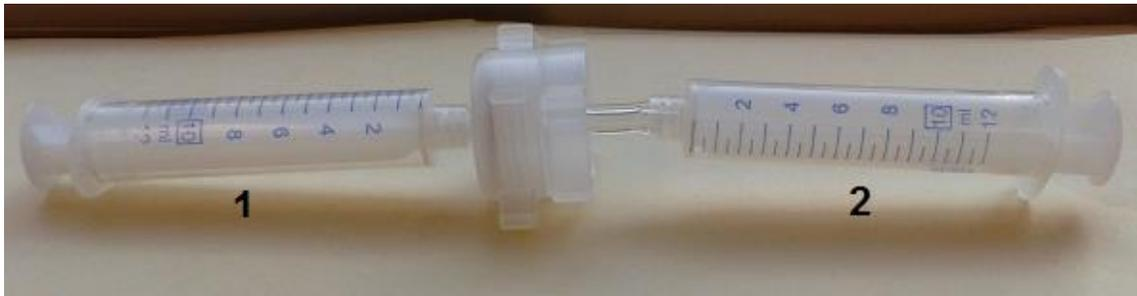
Figure 3-1 : Montage utilisé pour l'extrusion des liposomes
