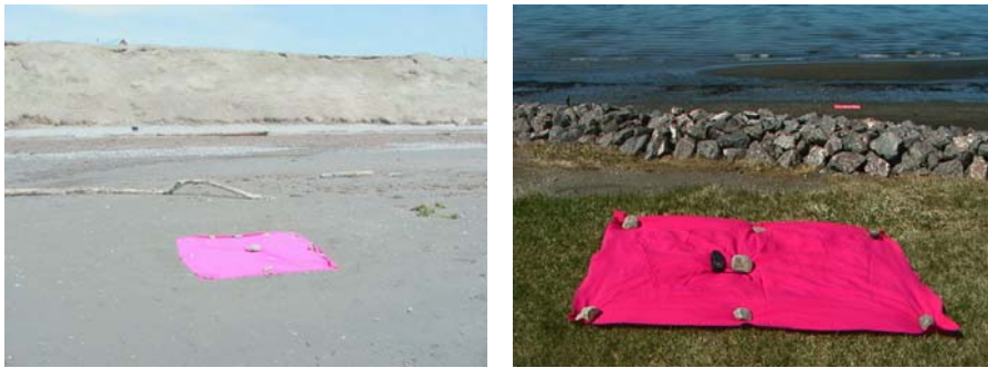
Figure 3.9 : Repères colorés utilisés comme points de contrôle.
