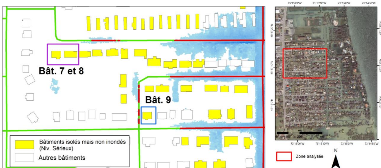
Figure 7.10: Identification de bâtiments non inondés mal identifiés comme « isolés »
