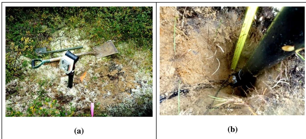
Figure 5-9 Un des capteurs de données du sol (température et contenu en eau) installé à Umiujaq
