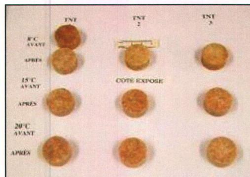
Figure 5.9.2. Physionomie du côté exposé à l'eau des échantillons de TNT sous forme de pastille après les essais de dissolution en conditions statiques
