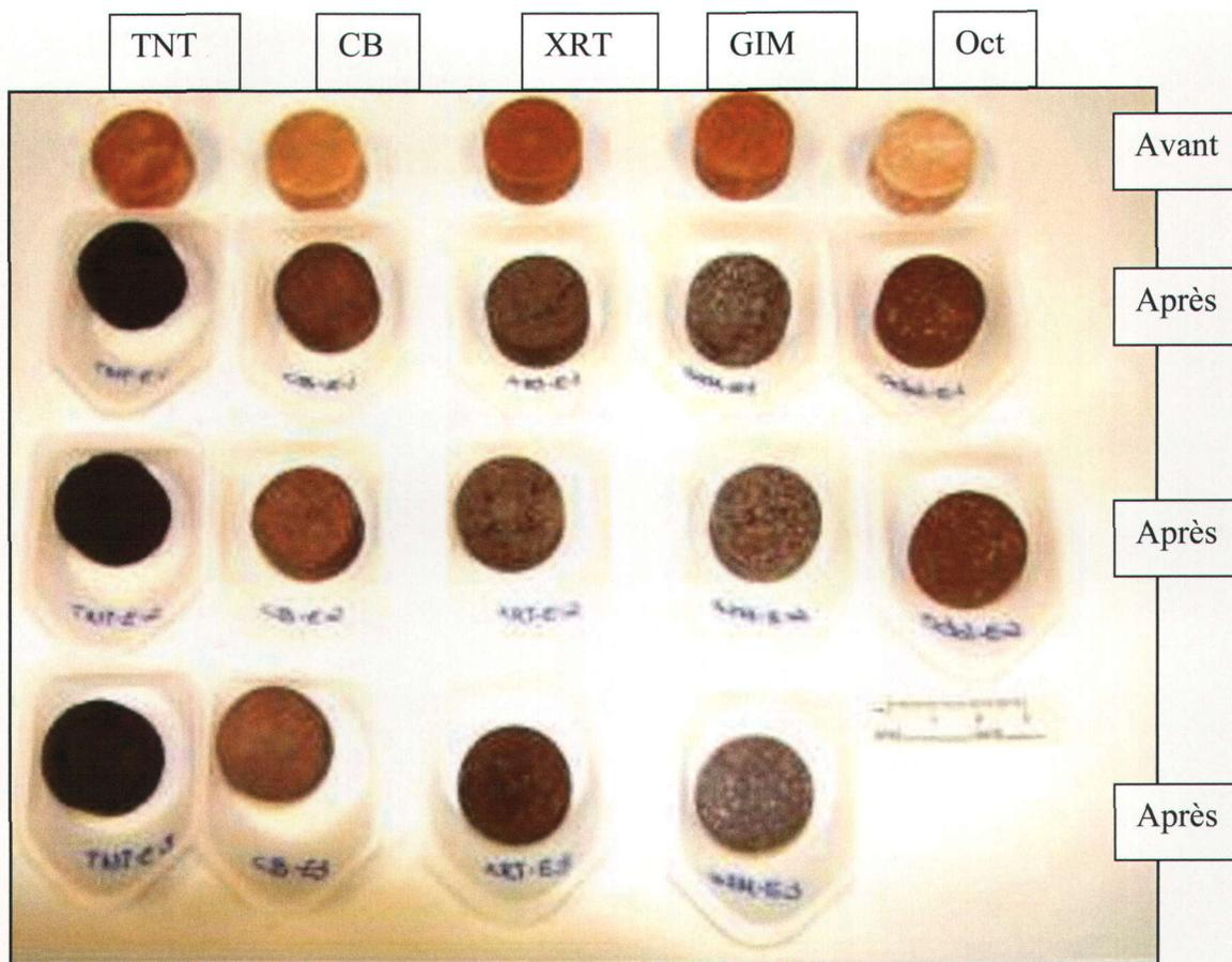
Figure 5.9.27. *Physionomie de l'ensemble des échantillons sous forme de pastille après leur exposition dans l'environnement (surfaces exposées à l'extérieur)*
