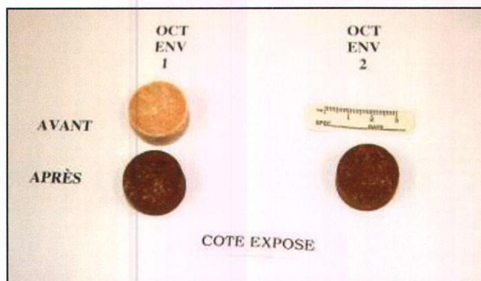
Figure 5.9.20. Physionomie des échantillons d'Octol sous forme de pastille après leur exposition dans l'environnement (surfaces exposées à l'extérieur)
