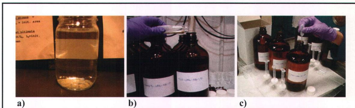
*Figure 4.5. Essais de dissolution en conditions statiques des échantillons sous forme de poudre*
