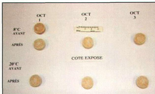
Figure 5.9.18. Physionomie des échantillons d'Octol sous forme de pastille après les essais de dissolution en conditions dynamiques
