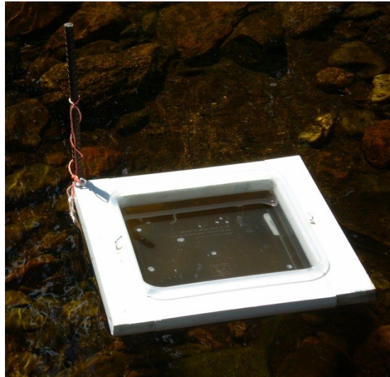
Figure 3.9 Minibac flottant déployé dans le ruisseau Catamaran à l'été 2012
