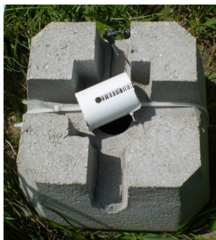
Figure 3.5 Exemple d'installation d'un thermographe à l'intérieur d'un tube de PVC et avec un bloc de béton comme ancrage pour son déploiement en rivière
