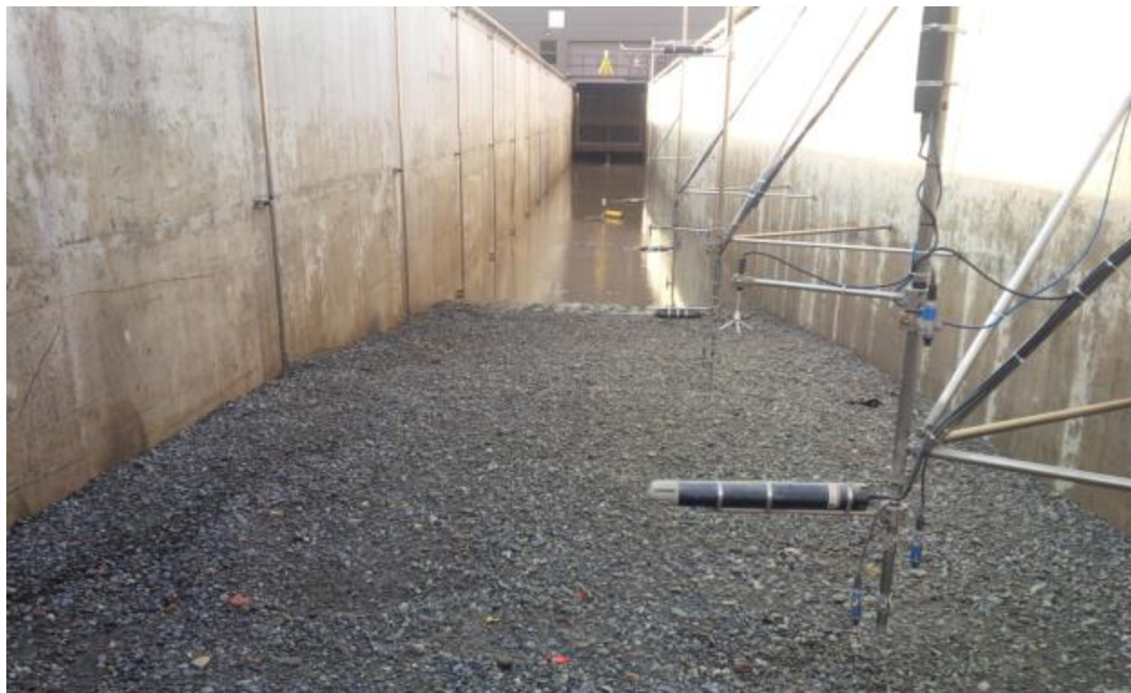
Figure 12. Position des appareils à la station 10 (avant-plan) et à la station 9, où deux des deux Aquadopp sont déployés à l'horizontale et mesurent les profils verticaux de courant
