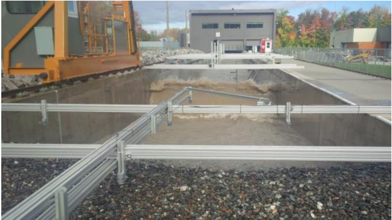
Figure 11. Vue longitudinale du canal hydraulique montrant un exemple de vague déferlant sur la plage de gravier en canal. Les supports en aluminium amovibles traversent le canal et supportent les jauges de niveau acoustiques.
