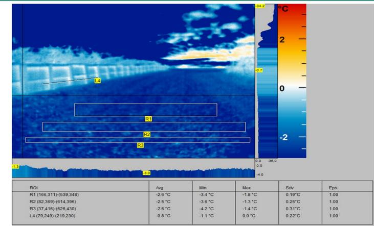
Les images infra-rouge montrent de manière claire que la température de surface du sol varie grandement de part et d'autre de l'obstacle sur une très courte distance (gradient de 1°C). Ce gradient est également observé sur les parois même de l'obstacle, épaisses de seulement 1.50 cm .
