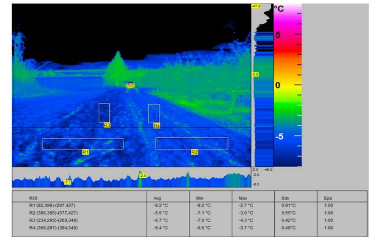
Des mesures répétées en absence d'obstacle soulignent l'influence de ce dernier sur les températures mesurées. On observe également, un phénomène de stagnation de l'air froid dans les dépressions et des effets de la rugosité du sol.
