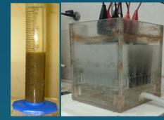
Tester les différentes méthodes de traitement des lixiviats\*\* (précipitation-coagulation et électrodéposition) et les comparer en termes d'efficacité, de pureté du produit final et de facilité de mise en œuvre.
