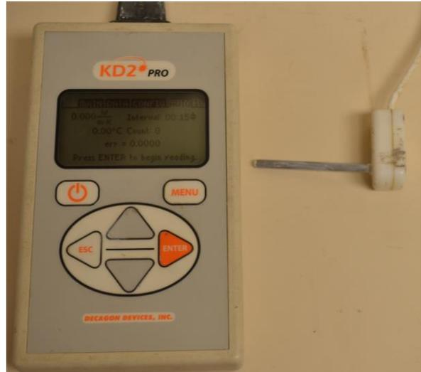
Figure 8 – Sonde à aiguille RK-1 et appareil calculant la conductivité thermique.
