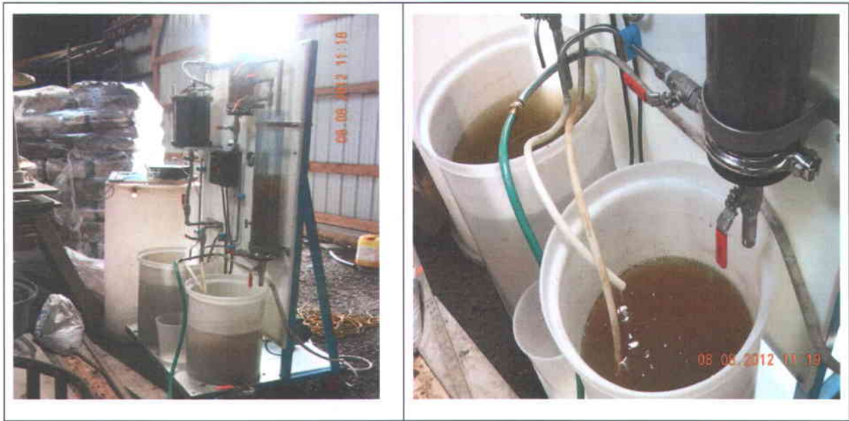
Figure 7 Photographie de l'unité expérimentale en mode opératoire continu sur site de pilotage (EC-ER, Fe/CV, I = 1,0 \text{ A} ; I = 2,0 \text{ A} ; I = 3,0 \text{ A} )
