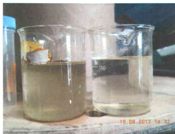
Figure 29 Effluent à l'entrée et à la sortie du système de traitement EC-ER (Fe/CV) sur site de pilotage en mode continu des EUD lors de l'essai EC-ER4 avec un bassin de recirculation de 40 L ( I = 2,0 A, TRH = 60 min, volume traité = 3 L)
