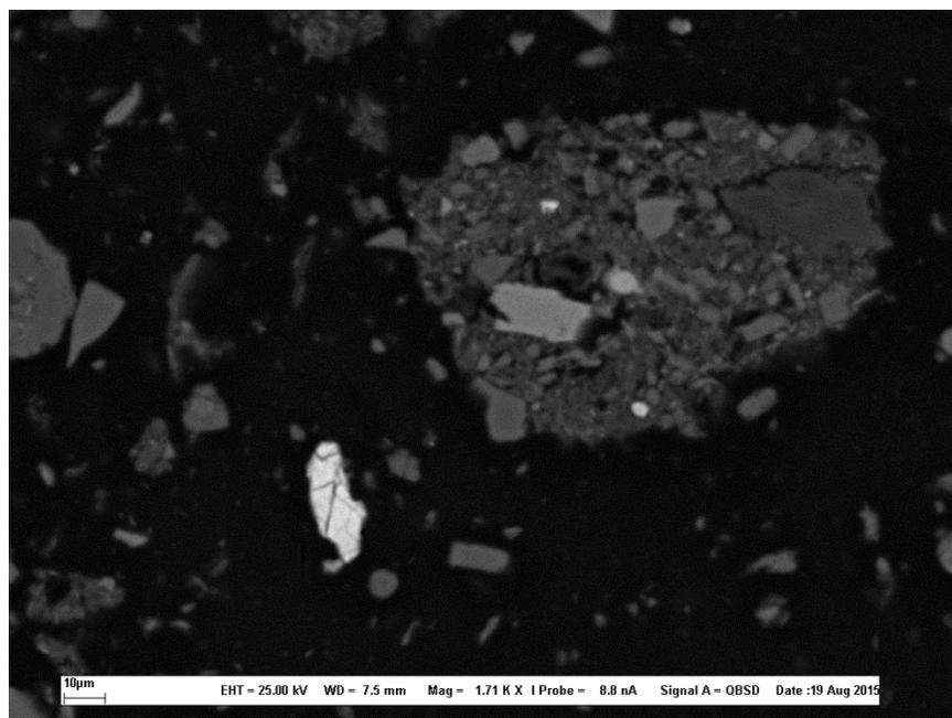
Figure 5.4 Image obtenue par MEB couplé à l'EDS: particule porteuse de Zn (en surbrillance) mêlé à du fer, du silicium et des carbonates (particule fortement libérée)
