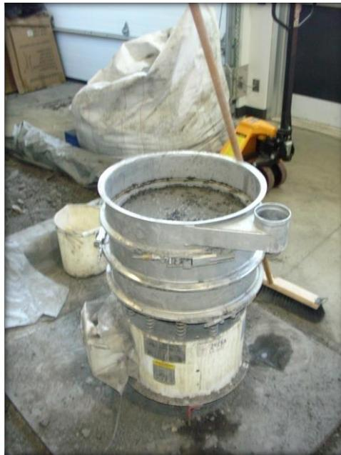
**Figure 4.2** Tamis Sewco<sup>TM</sup> utilisé pour l'étape de tamisage
