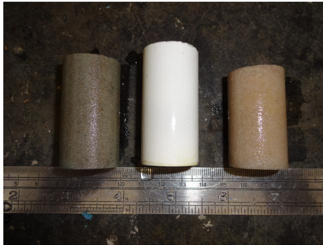
FIGURE 14 – Échantillons utilisés : Grès de Berea (gauche), céramique poreuse (milieu) et grès de Fontainebleau (droite)
