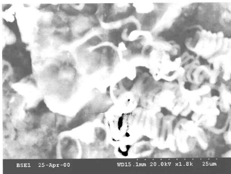
Figure 40 Image en électrons rétrodiffusés des écailles de cacao ayant du plomb adsorbé (1800x)
