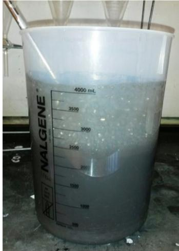
**Figure 3-2** Montage de mise à l'échelle du procédé de lixiviation acide et basique de la fraction < 125  $\mu\text{m}$  de sol CMR28
