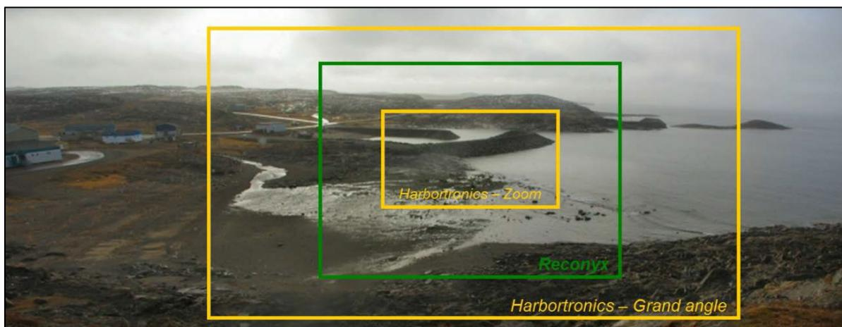
Figure 2 - Comparaison des champs de vision des caméras à Quaqaq. L'Harbotronics - Grand angle permet de voir la glace sur l'ensemble de la baie, tandis que l'option zoom de l'Harbotronics et le champ de vue de la Reconyx se concentrent sur les infrastructures maritimes.
