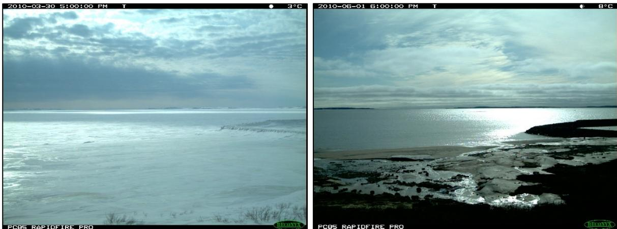
Figure 3 - Effet des conditions climatiques. L'ombre présente sur l'image de gauche peut se confondre avec de l'eau alors que le reflet sur l'image de droite peut être confondu avec de la glace
