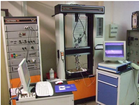
Figure 33 - Photos du montage expérimental couplant mesures électrochimiques, d'EA et de force
