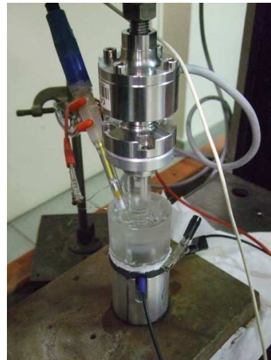
Figure 33 - Photos du montage expérimental couplant mesures électrochimiques, d'EA et de force
