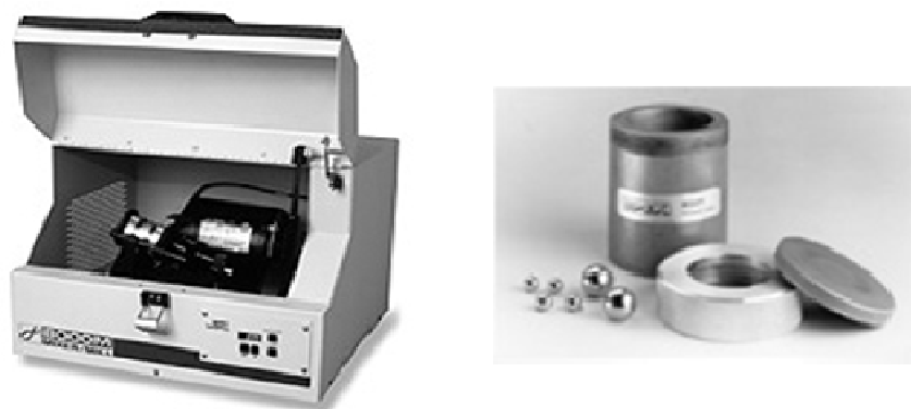
Figure 26 - Broyeur vibratoire Spex 8000M et creuset de broyage
