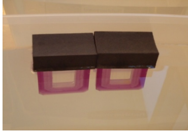
Figure 2.5 : Montage expérimental pour évaluer le temps nécessaire de l'atteinte de l'équilibre des métaux liés sur la résine dans la cassette avec ceux de la solution externe.
