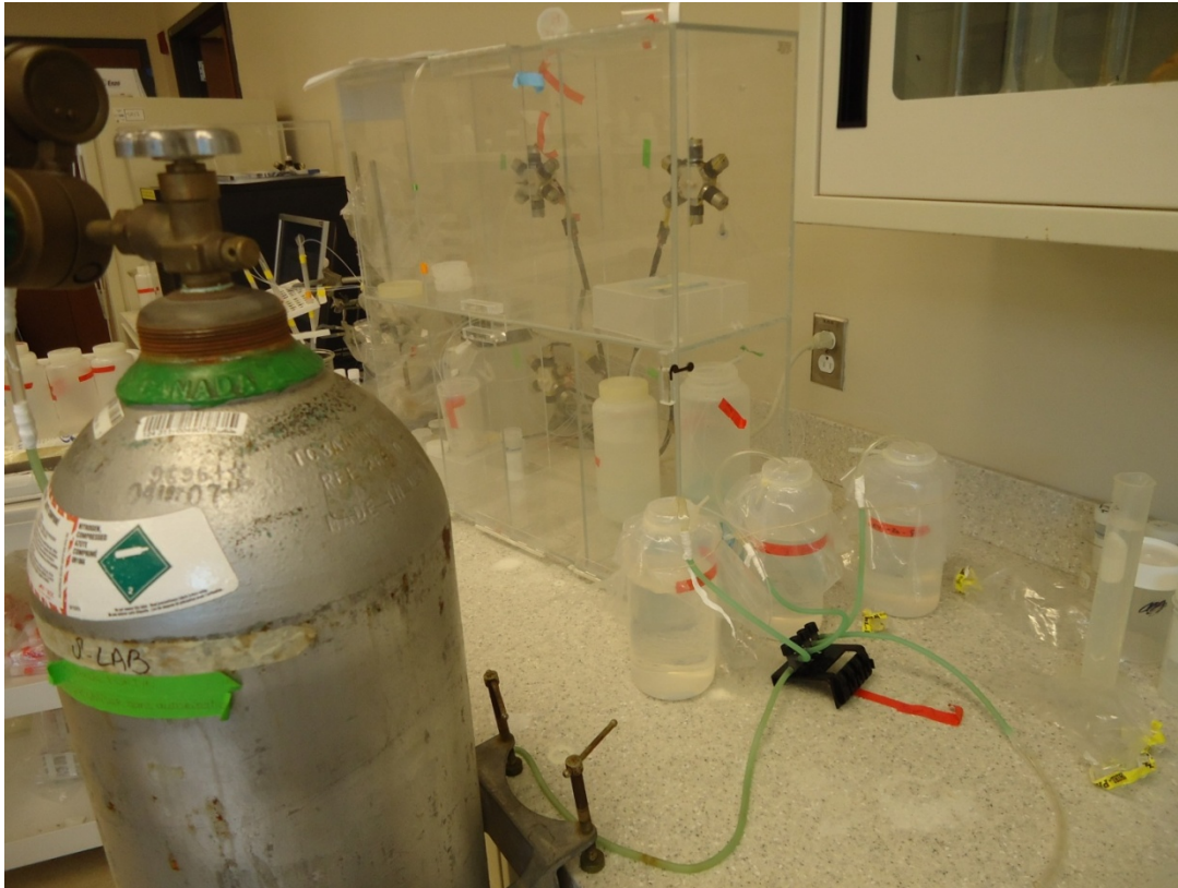
Figure 2.8 : Montage expérimental de l'étalonnage des solutions à pH 8.3.
