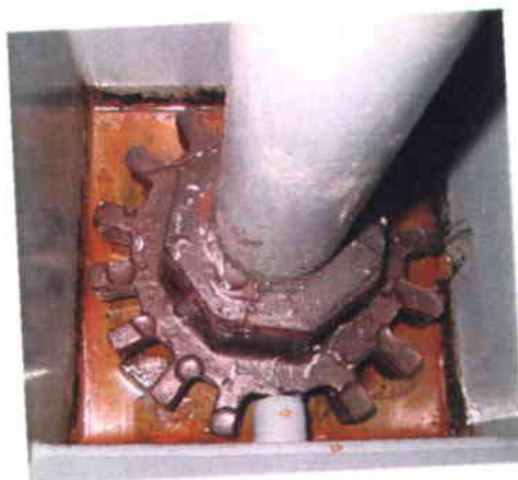
Figure 3.10 Photographie de l'intérieur d'une cellule de flottation du banc de flottation utilisé lors des essais
