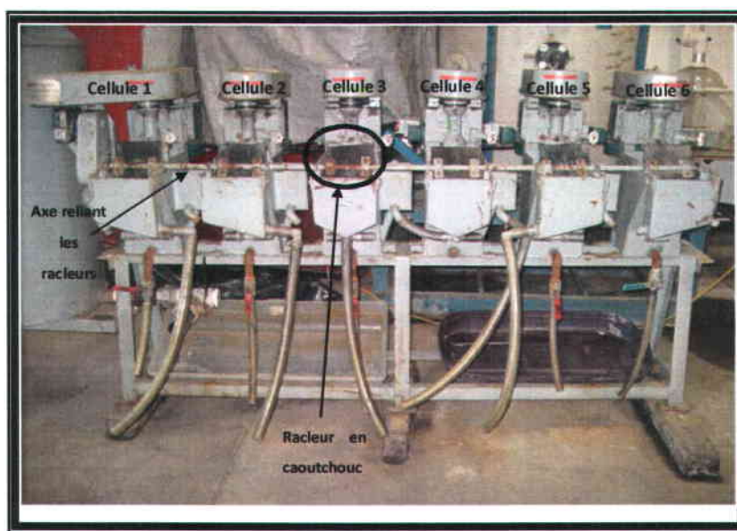
Figure 3.11 Photographie du banc de flottation de six cellules de 8 L de capacité par cellule
