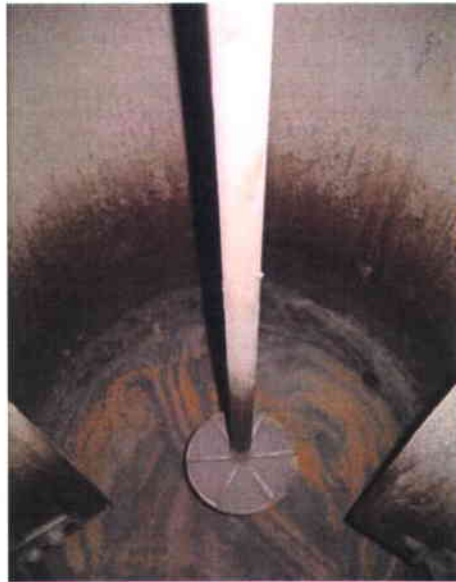
Figure 3.8 Cellule d'attrition utilisée lors des essais d'attrition
