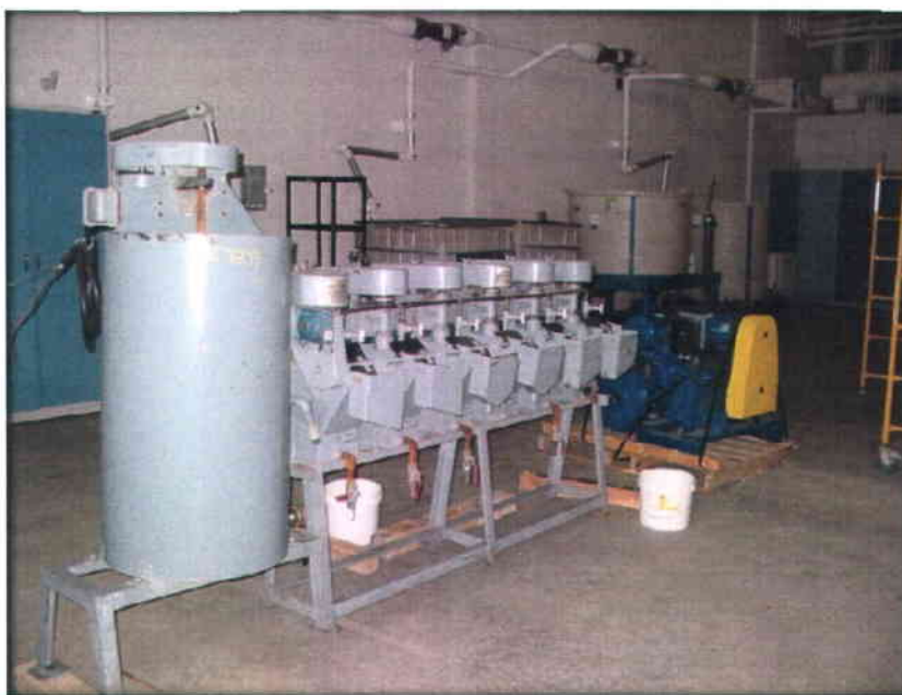
Figure 3.3 Banc de cellules de flottations utilisé lors des essais
