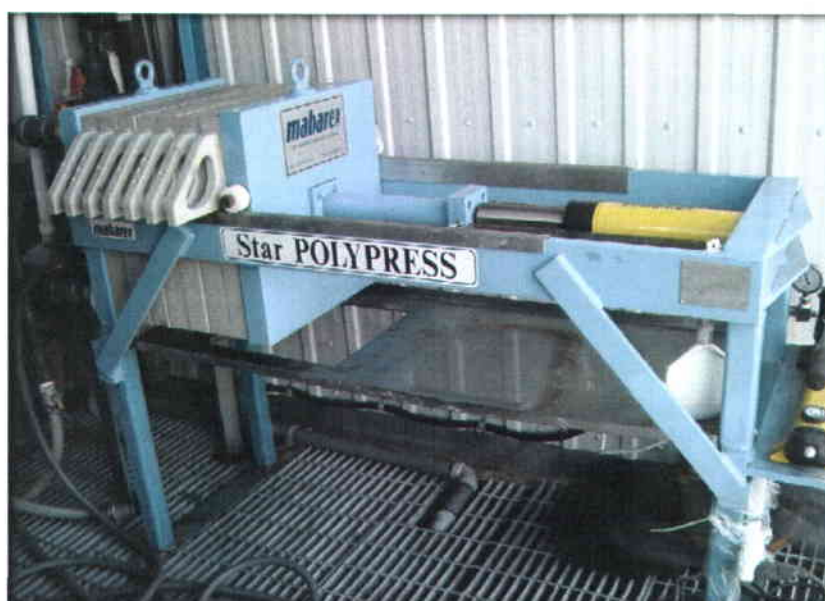
Figure 3.5 Filtre-presse utilisé pour les essais
