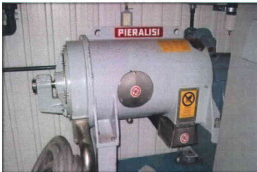
Figure 3.4 Centrifugeuse en continu de marque PIERALISI (modèle Baby one) utilisée pour les essais de centrifugation
