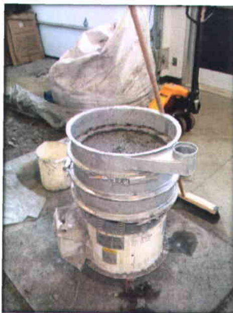
Figure 3.2 Tamis Sweco utilisé pour effectuer les essais de tamisage
