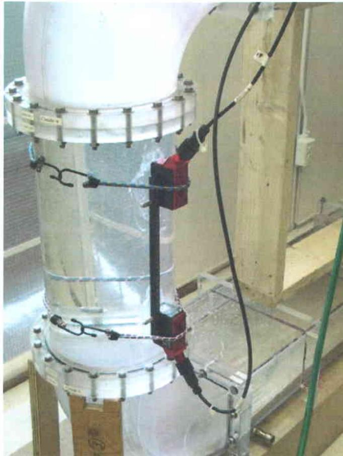
Figure 137. Capteur Doppler de la partie descendante du canal
