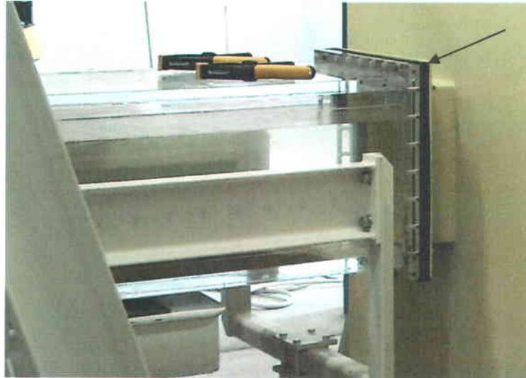
**Figure 148.** Photographie du joint d'étanchéité déformable de 25.4 mm installé entre la partie d'acrylique et le réservoir.
