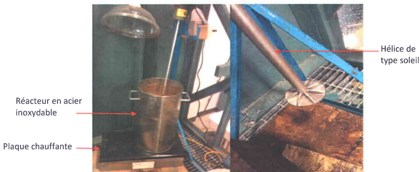
Figure 2.2 Photographie du dispositif expérimental utilisé pour la lixiviation basique
